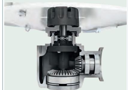
*Der Sensor sitzt in der Antriebswelle der Scheiben. Der Verlauf der Feldlinien der magnetisierten Welle ändert sich proportional zum Drehmoment.*
