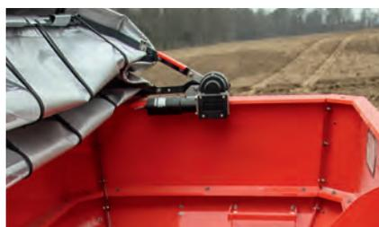
Maximal darf der Streuer jetzt 4,2 t zuladen. Es gibt auch so feine Details wie eine elektrische Betätigung der Plane.
