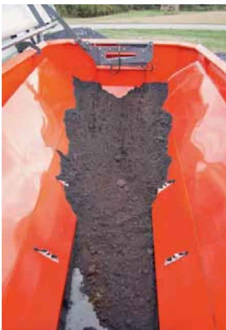
Zum Kalkstreuen wird das Gitter aus dem Behälter genommen. Durch die trichterförmige Behälterform und die versteckt angeordnete Bandabdeckung läuft der Kalk gut nach.
