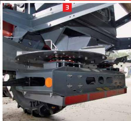
**1** Elektrische Aufgabepunktverstellung und hydraulischer Scheibenantrieb zeichnen den Axis bei der Arbeit aus.
